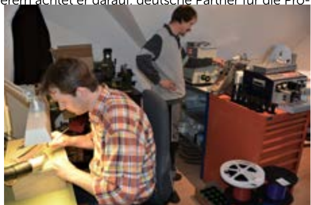
Bei Modellbau Schönwitz werden von Hand kleine LED-Ketten verlötet oder Drahtspulen gewickelt.
