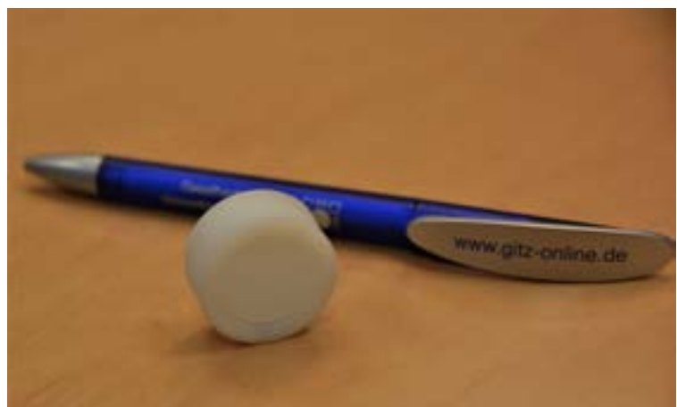
Der Adsorber von Biontis verfügt im Innern über eine riesige, mikroskopisch kleine Oberfläche.
