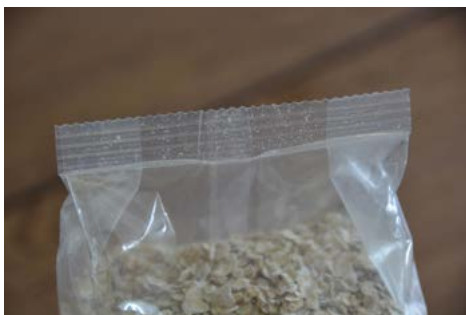
Verpackungen werden unterschiedlich verschlossen und müssen dicht abschließen, selbst wenn Stäube - wie hier bei Haferflocken - anfallen.
